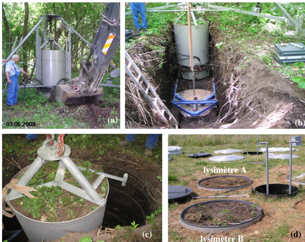
Figure 4 : Prélèvement des monolithes de sol dans le bassin de décantation et installation à la station expérimentale du GISFI (d) en juin 2009 : introduction verticale du lysimètre dans le sol à l'aide du dispositif de piquage, pré-découpage de la colonne par le dispositif de fraisage installé au pied et dégagement progressif du lysimètre avec une pelle mécanique (a) jusqu'à 2 m de profondeur puis séparation de la colonne par une lame circulaire (b) et extraction de la colonne (c) (photographies GISFI)
