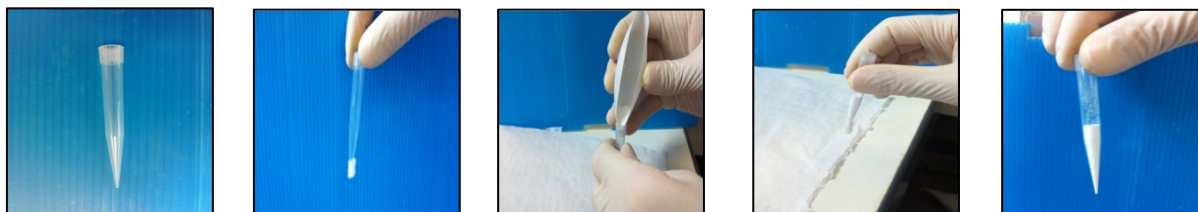
Figure 28: Etapes de préparation de lit de poudres pour la montée capillaire.
