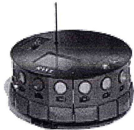
(b) Ceinture de capteurs à ultrasons sur le mobile Magellan (I-Robots, Real World Interface, Div U.S.A.)
