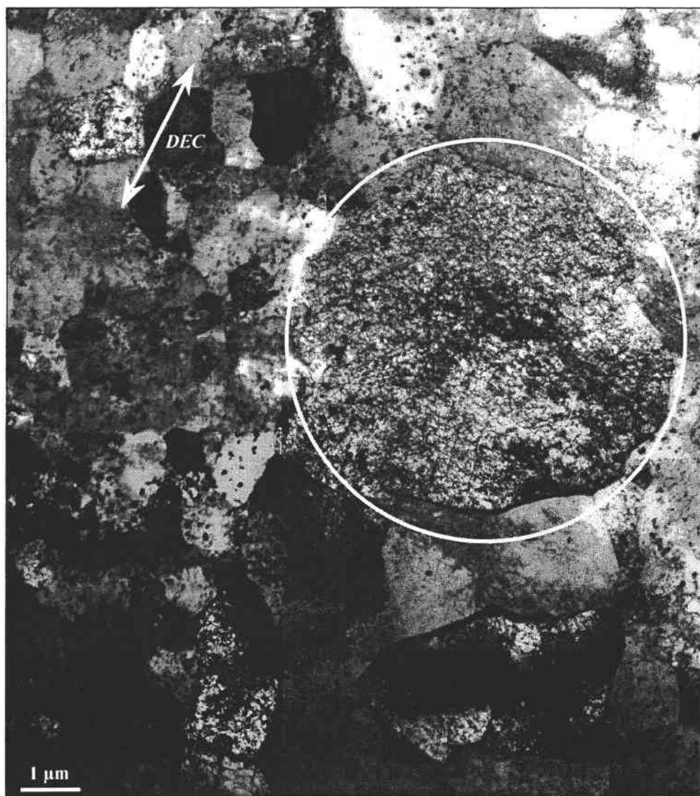
Figure III.13 : Assemblage de clichés MET illustrant la microstructure du matériau PL Ia selon une coupe parallèle à l'axe de la barre.
