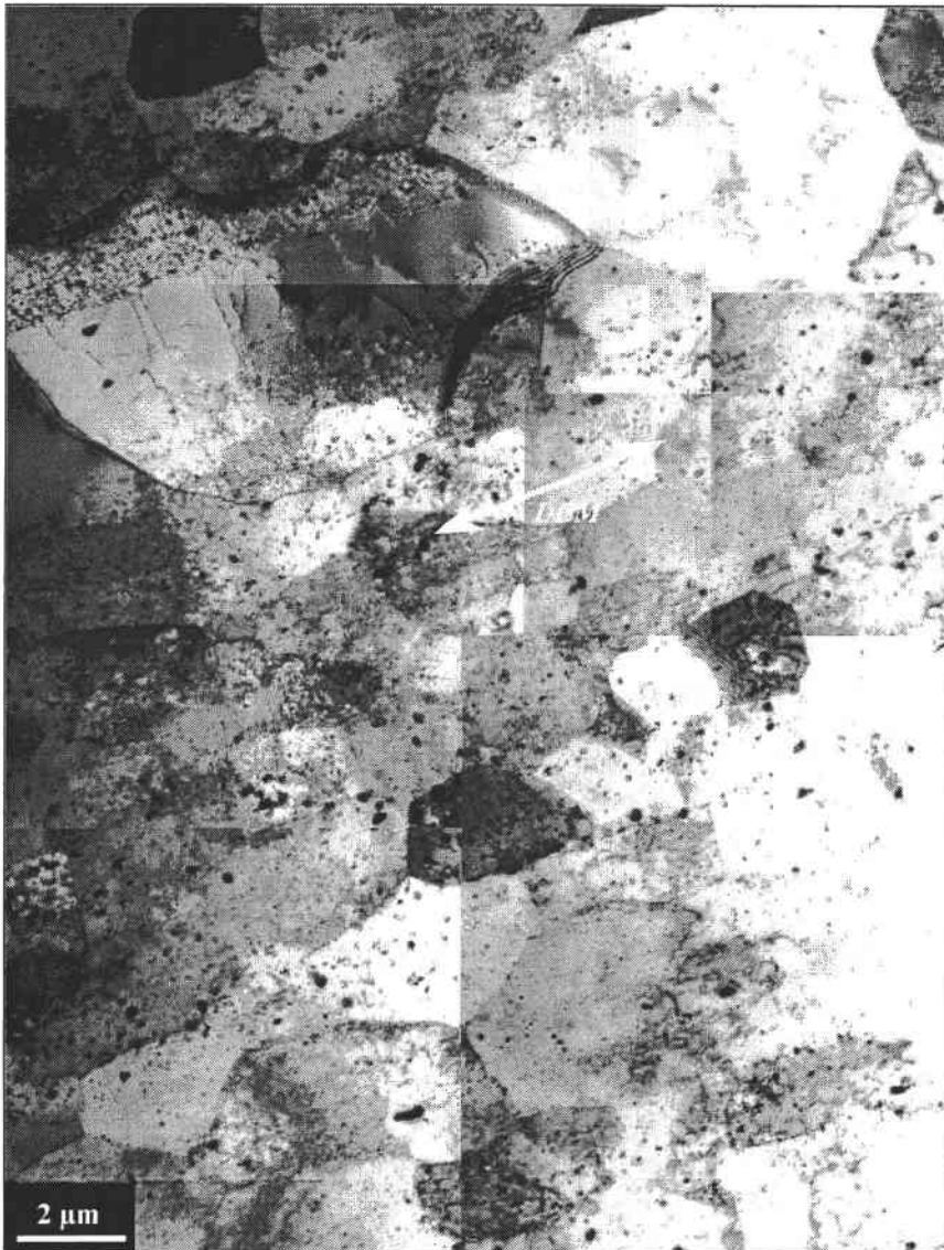
Figure III.20 : Assemblage de clichés MET illustrant la microstructure du matériau PL Ie selon une coupe parallèle à l'axe de la barre.
