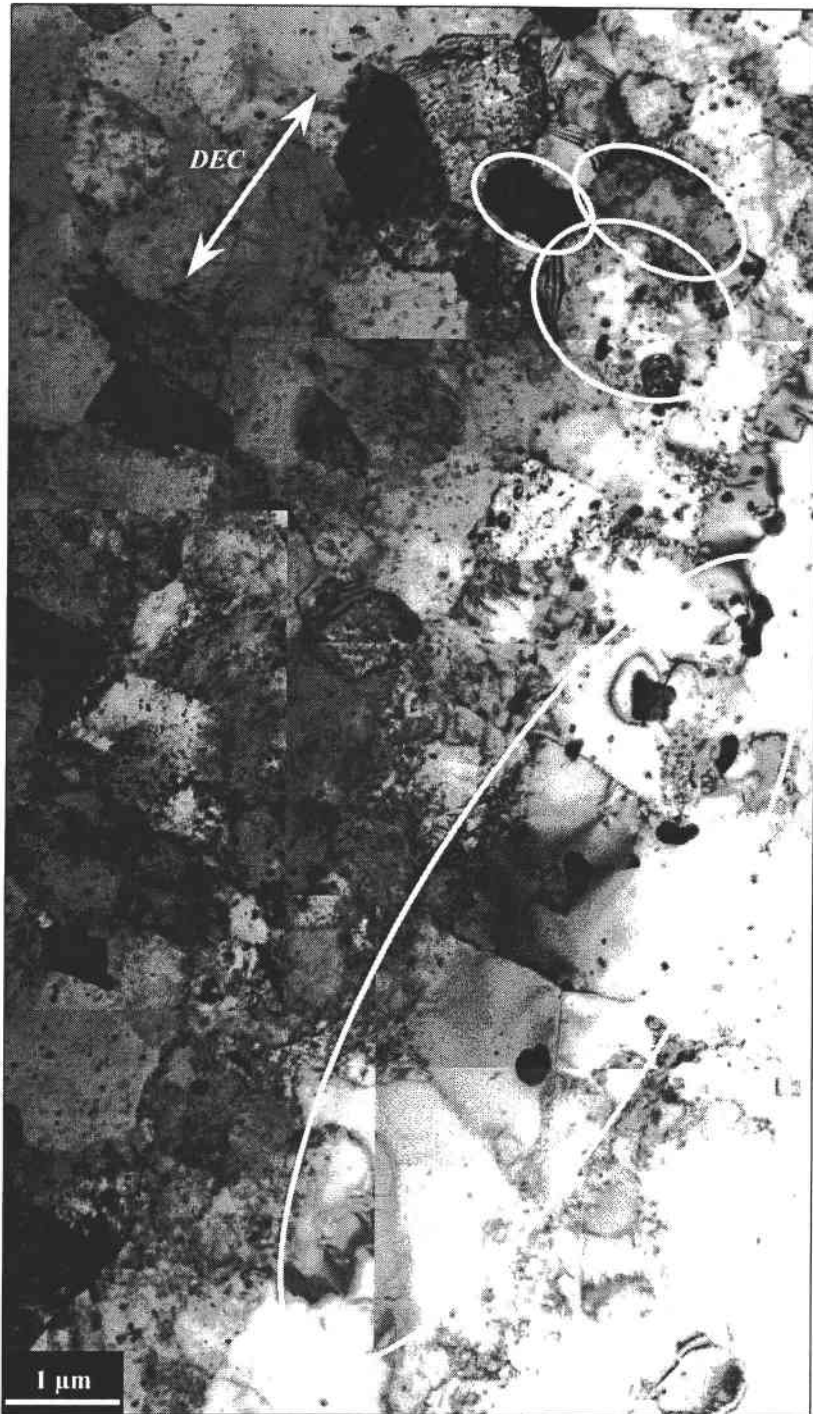
Figure III.15 : Assemblage de clichés MET illustrant la microstructure du matériau PL Ib selon une coupe parallèle à l'axe de la barre.
