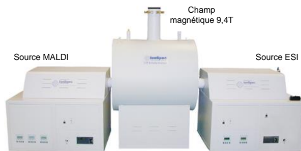
Figure III-2 : Spectromètre de masse FTICR Explorer QFT-9 (Varian).
