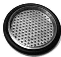
**Figure 5.21** Photographie de la grille servant à stabiliser l'écoulement en amont de l'enceinte ventilée
