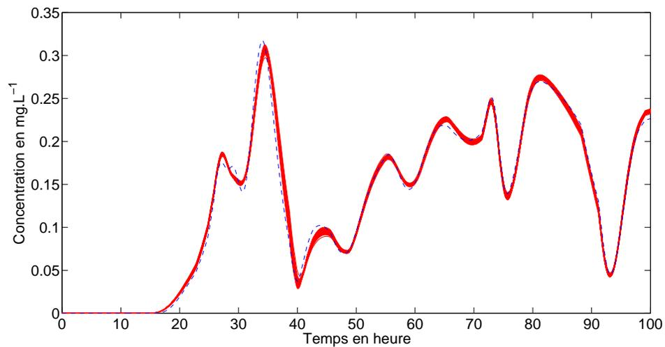
FIGURE 3.7 – Concentration prédite pour une simulation de Monte Carlo de 100 jeux de données (méthode SRIVC-EDP-LPV) pour  $x = 1, 2$  km, les courbes rouges représentent les concentrations prédites, la courbe bleue représente la concentration déterministe
