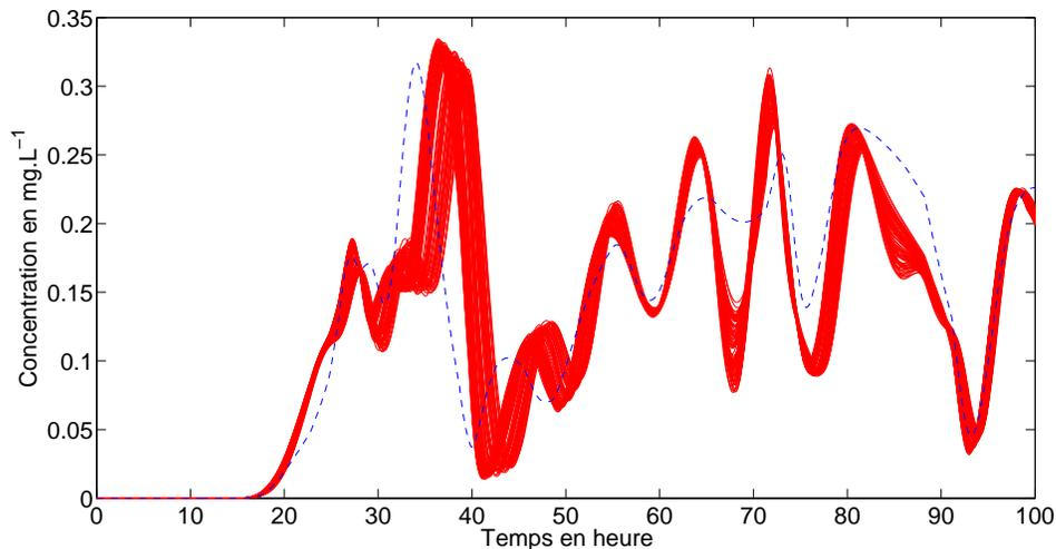
FIGURE 3.5 – Concentration prédite du modèle pour une simulation de Monte Carlo de 100 jeux de données (méthode SILS-EDP-LPV) pour  $x = 1, 2$  km, les courbes rouges représentent les concentrations prédites, la courbe bleue représente la concentration déterministe
