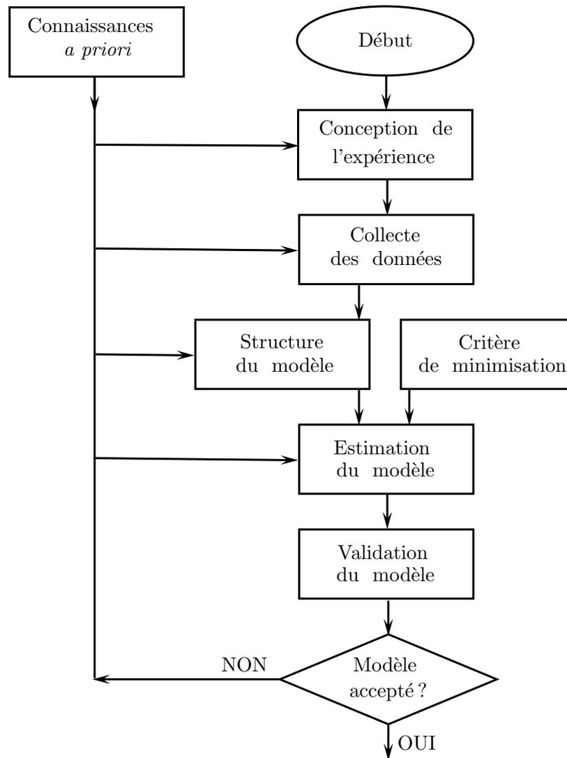
FIGURE 1.4 – Procédure itérative d'identification des systèmes
