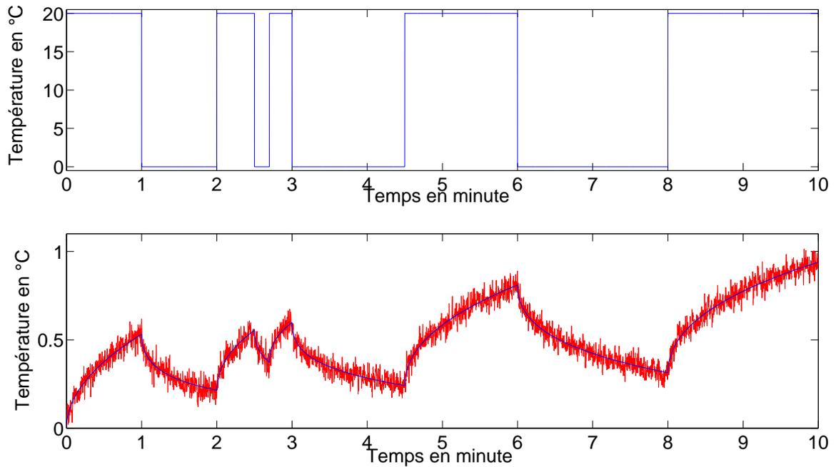
FIGURE 2.3 – Source de chaleur (partie supérieure) et température de la barre à  $x = 3,33$  cm pour une réalisation de bruit coloré (partie inférieure), la courbe bleue correspond à la température déterministe et la courbe rouge à la température bruitée mesurée
