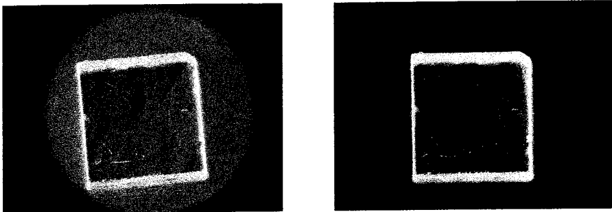
Cristaux \beta -BBO observés sous microscope entre polariseur et analyseur croisés. Cette photo révèle les contraintes présentes dans certaines zones du cristal.
