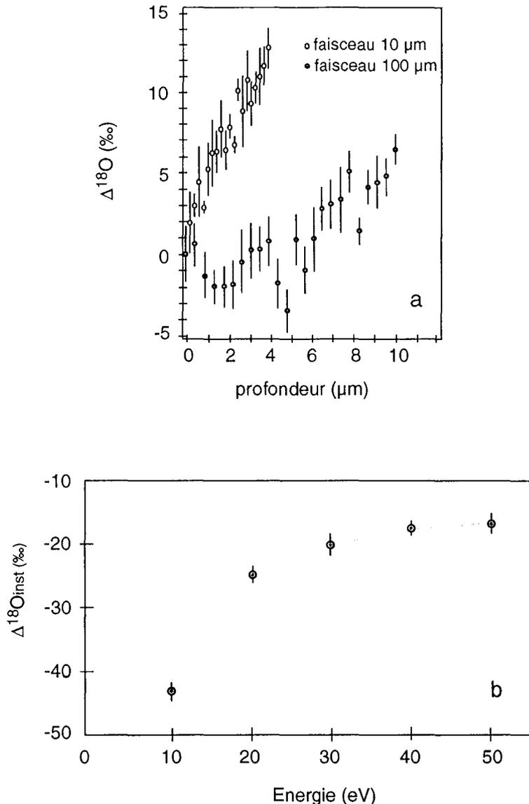
Figure 1.18 (a) Effets isotopiques topographiques sur section polie similaires à ceux observés sur micrograins, (b) variation du fractionnement instrumental en fonction de l'énergie des ions secondaires sur section polie (données non publiées, McKeegan). Ces données sont à comparer avec celles présentées dans Aléon et al., 2000a. Elles montrent que la topographie de la surface analysée peut être responsable d'un fractionnement instrumental positif des isotopes de l'oxygène.
