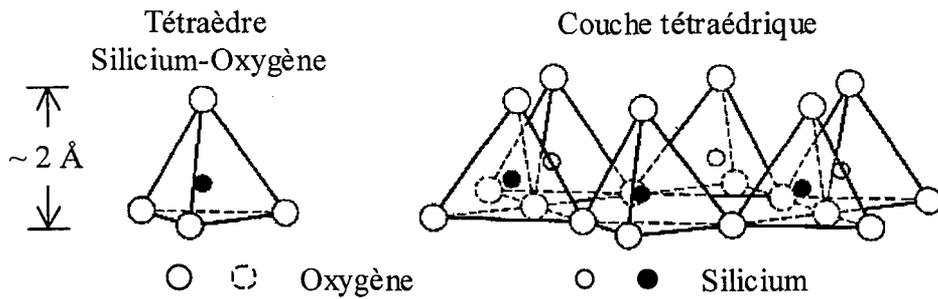
Figure 2~1 : Diagramme d'un tétraèdre et d'une couche tétraédrique
