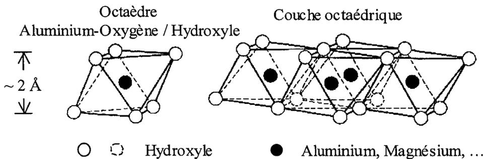
Figure 2~2 : Diagramme d'un octaèdre et d'une couche octaédrique
