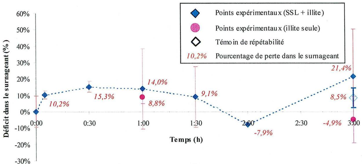
**Figure 2~13 : Résultats de l'essai batch avec de l'illite**
