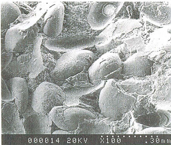
Figure 4 - Vue au MEB du minerai de fer sain.
