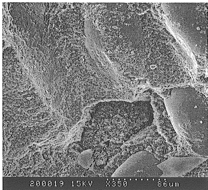
Figure 10 - Phyllosilicates néoformés dans un vide du minerai prélevé en bord de pilier.
