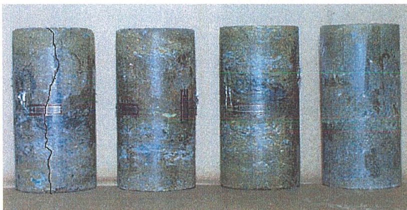
Figure 12 - Epreuves du minerai carbonaté sain après essai triaxial.
