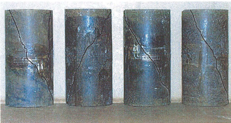
Figure 8 - Epreuves du minerai ferrifère sain après essai triaxial.
