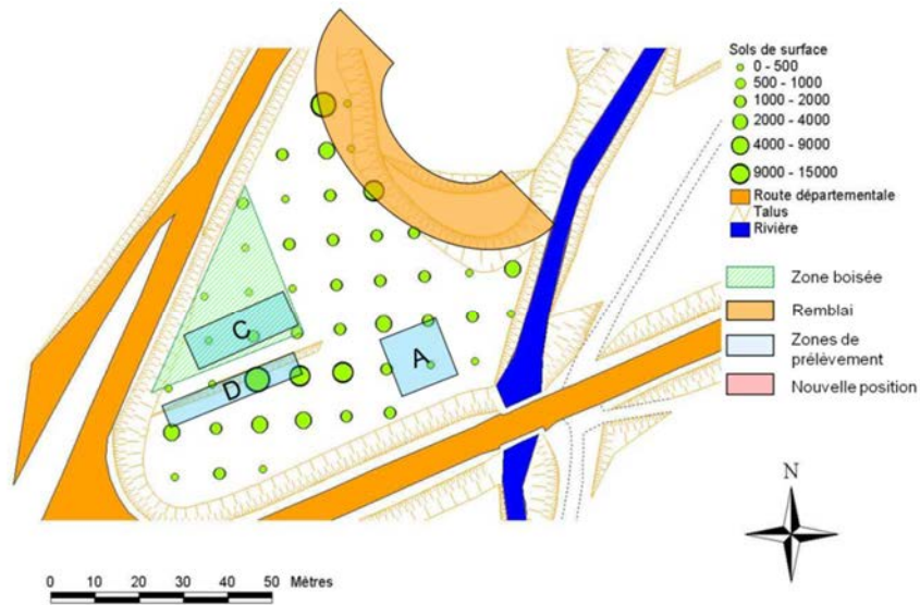
Figure 19 : Représentation cartographique avec une maille de 10 mètres des concentrations en arsenic (mg As/kg sol sec) pour des prélèvements en surface de 0 à -20 cm. Les points verts représentent les concentrations en arsenic (Laperche et Eisenlohr, 2001). Les lettres A, C et D indiquent les zones de prélèvements.
