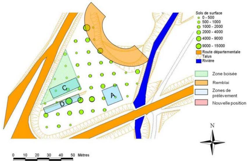
*Figure 19 : Représentation cartographique avec une maille de 10 mètres des concentrations en arsenic (mg As/kg sol sec) pour des prélèvements en surface de 0 à -20 cm. Les points verts représentent les concentrations en arsenic (Laperche et Eisenlohr, 2001). Les lettres A, C et D indiquent les zones de prélèvements.*
