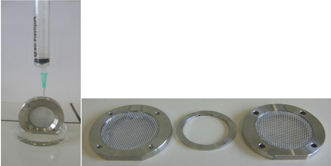
Figure 16 : Technique de moulage (Image à gauche), moule pour la formation des cylindres alginate/HA ou alginate/HAP
