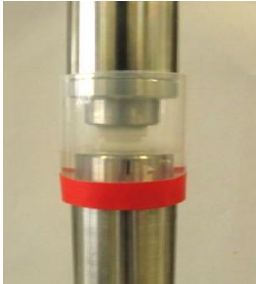
Figure 17: Dispositif de compression uniaxiale en immersion
