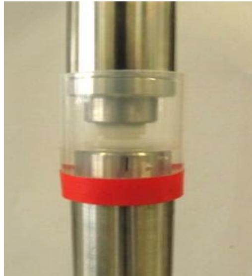
**Figure 17: Dispositif de compression uniaxiale en immersion**
