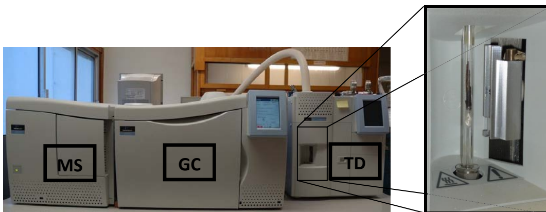
Figure 31. Couplage thermodesorbeur - chromatographe gaz - spectromètre de masse
