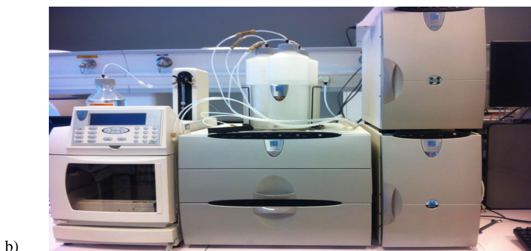
Figures 2.14 (a, b) : Schéma de principe de la Chromatographie Ionique (Académie de Paris, 2011) (a) ; ICS-3000 Ion Chromatography System (b)
