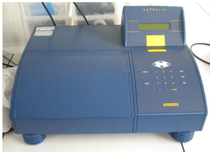
Figure 2.10 : Spectrophotomètre SECOMAM Anthélie Junior
