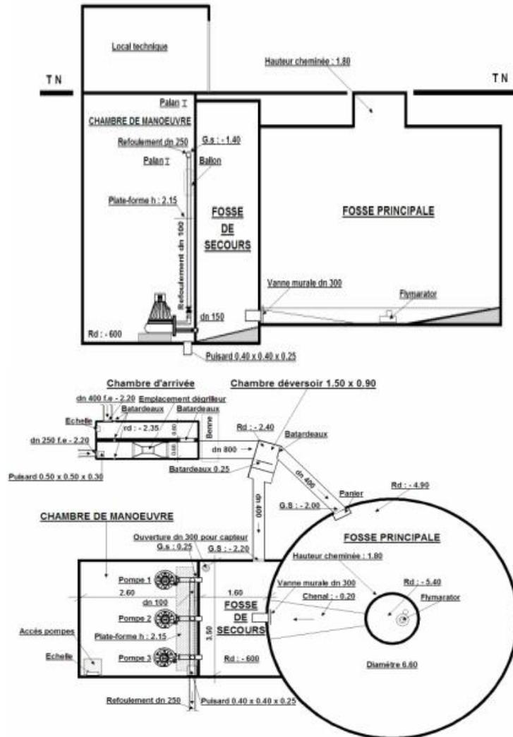
Figure 2.4 : Schéma du poste de refoulement de Clairlieu
