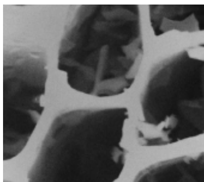
Figure 14 : Détail des pores d'un charbon de bois montrant des dépôts de carbone graphitique sur leur surface (Miura M. et coll. 2004).
