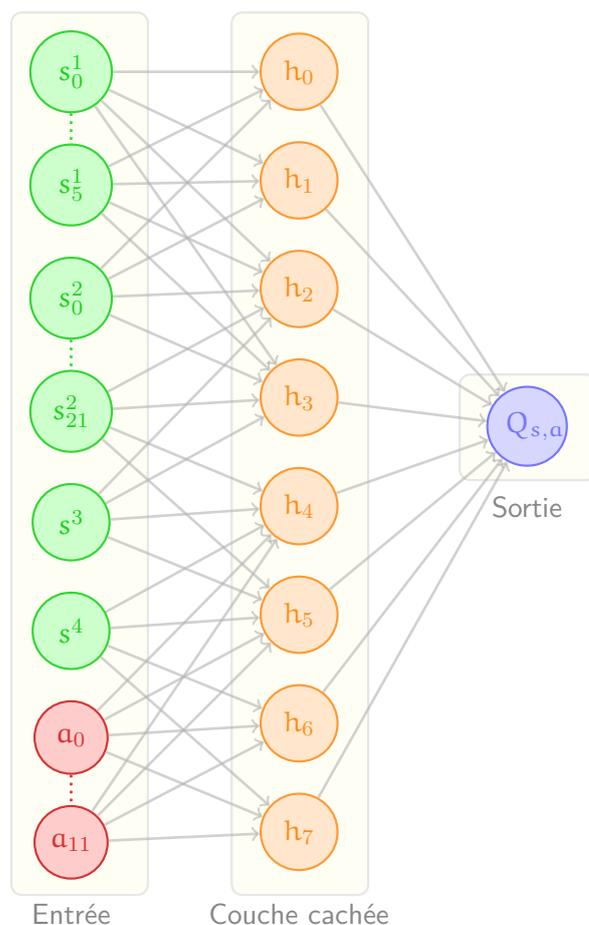
**Figure 5.9** – Illustration du réseau utilisé pour approximer la fonction de qualité. Pour des raisons de lisibilité, toutes les connexions de la couche d'entrée vers la couche cachée n'apparaissent pas.
