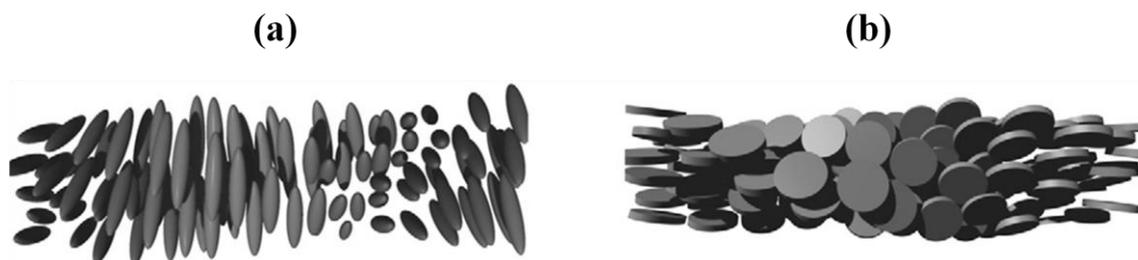
**Figure I-17. Principales morphologies des mésogènes. (a) mésogènes calamitiques, (b) mésogènes discotiques.**
