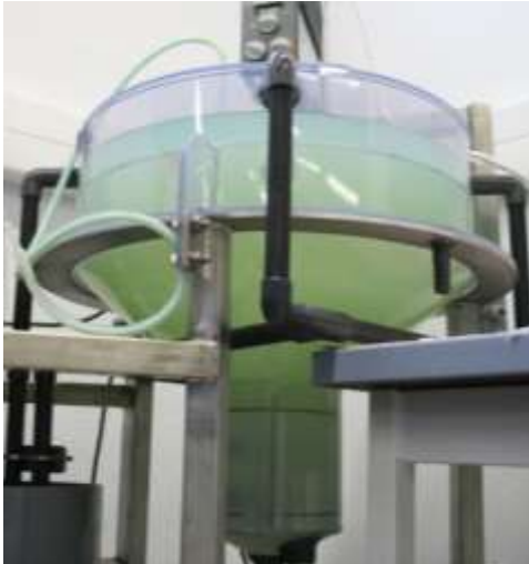
Figure 137 : Photo du réacteur/décanteur continu durant l'essai de décontamination du césium par le PPF e Ni
