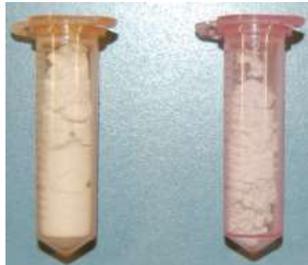
Figure 104 : Flacons de poudres de \text{BaSO}_4 utilisés pour mettre en évidence la répartition du strontium au sein d'un grain de \text{BaSO}_4
