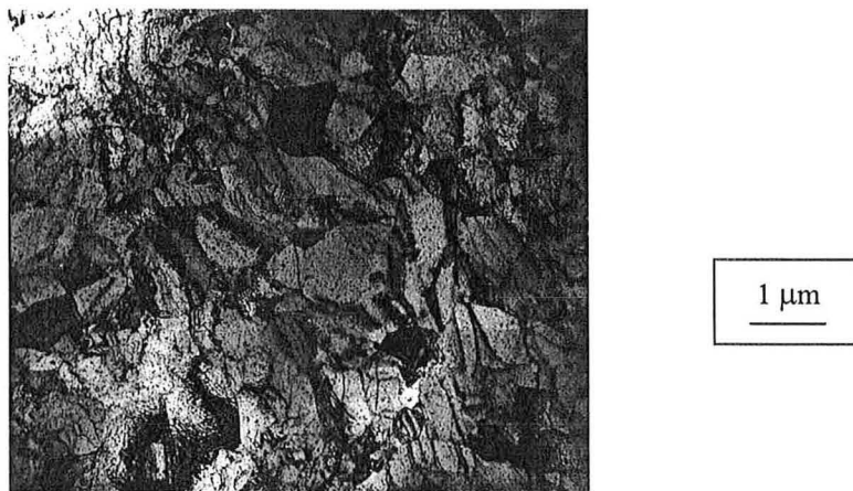
Figure VI.7 : Micrographie MET de la structure de l'acier IF-Ti à 1% de cuivre après laminage à froid à 75% et recuit continu à 750°C
