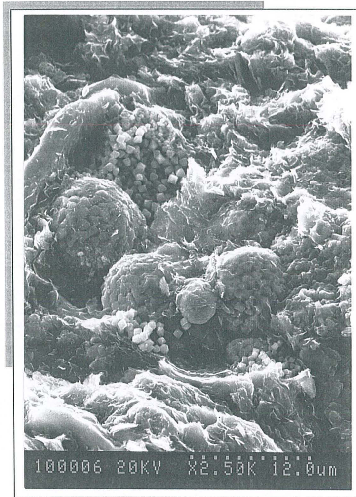
Figure 73 : Argilites du Callovo-Oxfordien observées en mode secondaire. Amas d'octaèdres de pyrite enchevêtrés dans une pellicule d'argile.
