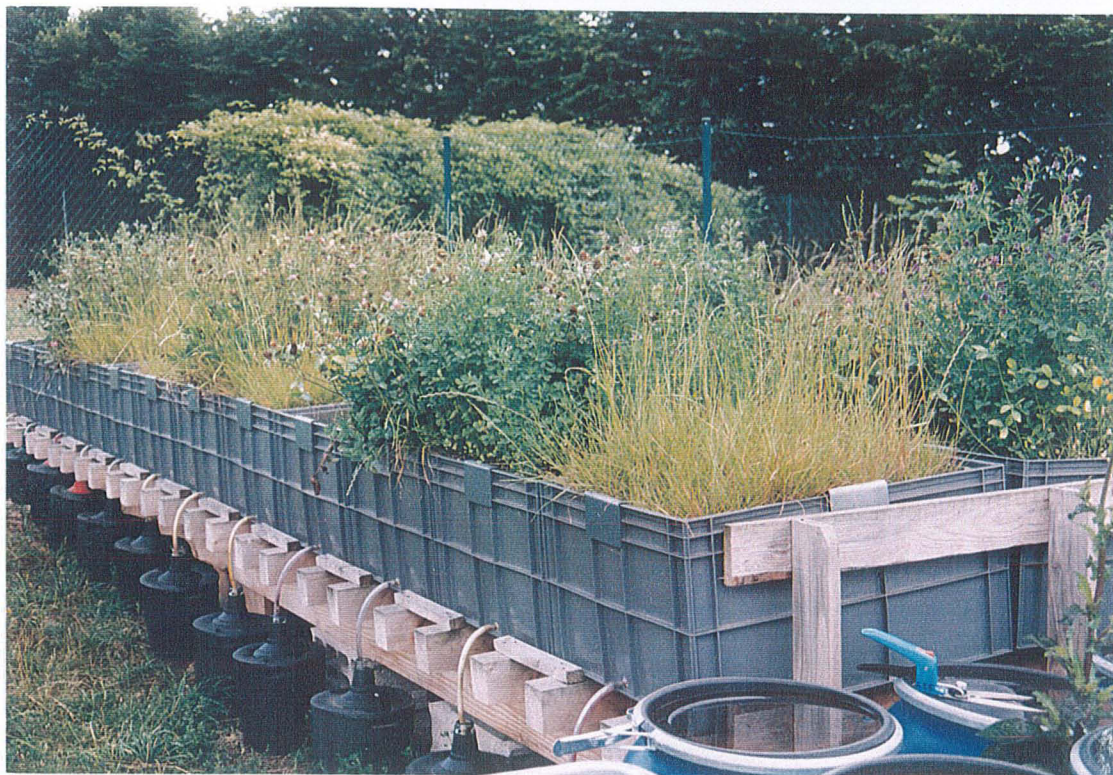
Photographie 7 : Dispositif de lysimètres
