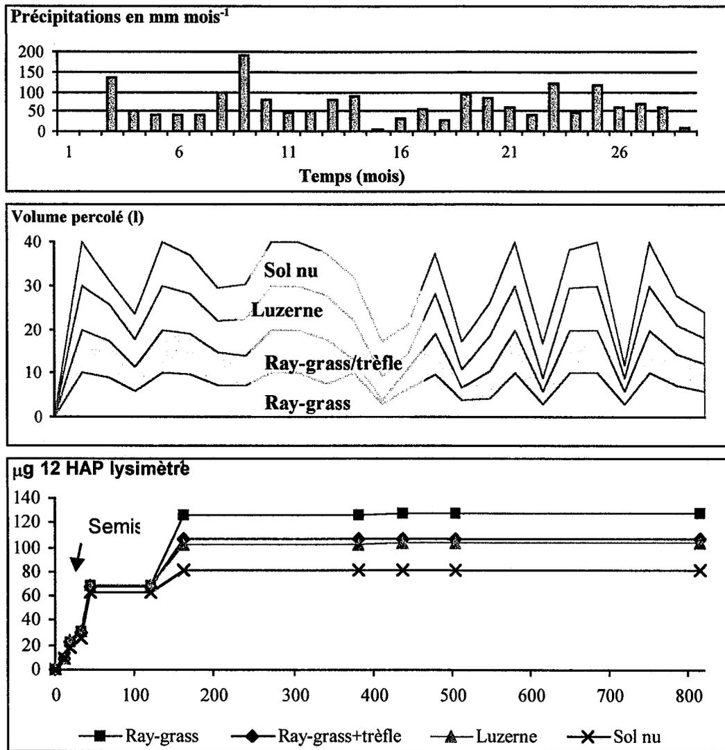
**Figure 63 :** Pluviométrie, volume d'eau percolé et quantité moyenne cumulée de 12 HAP exportés à partir des lysimètres de terre d'ancienne usine à gaz G2 (3500 mg HAP  $\text{kg}^{-1}$  terre) au cours des 2,5 ans du traitement.
