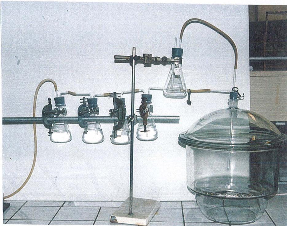
**Photographie 6 :** Dispositif expérimental mis en place pour l'étude du transfert du phénanthrène et du benzo[a]pyrène à partir d'un sol vers les parties aériennes de plantules de maïs, en enceintes fermées (d'après Scheunert *et al.*, 1986).
