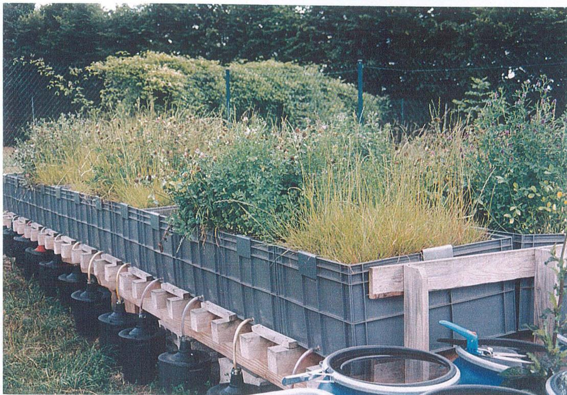
Photographie 7 : Dispositif de lysimètres
