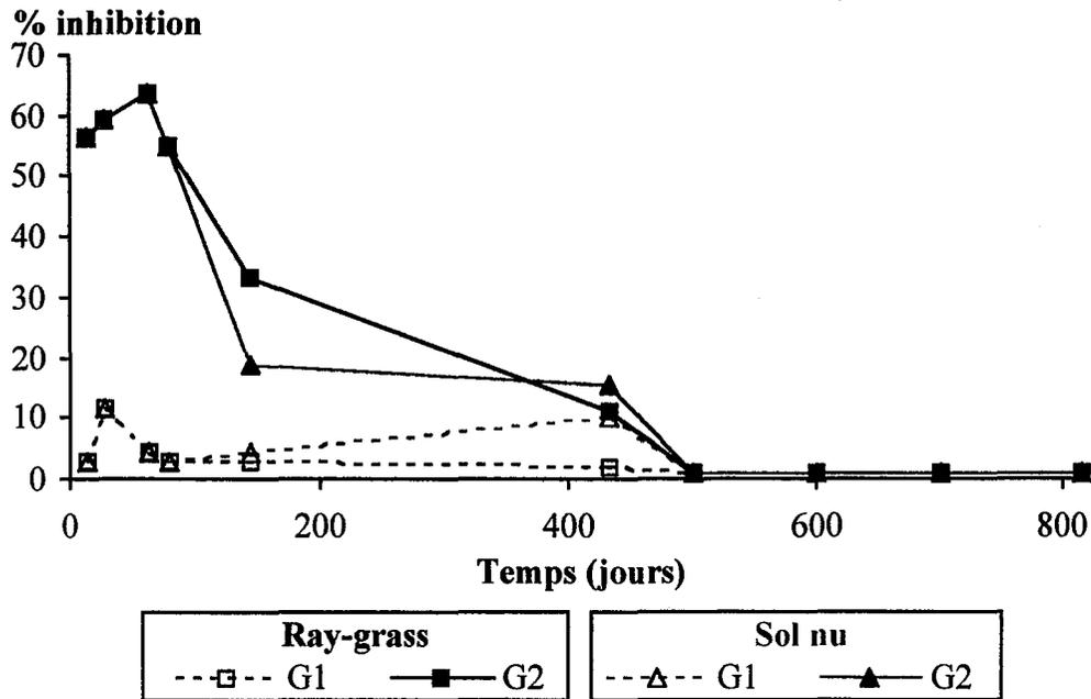
**Figure 61** : Inhibition de la germination du trèfle violet par les lixiviats des terres d'AUG G1 (1600 mg HAP kg<sup>-1</sup> terre) et G2 (3500 mg HAP kg<sup>-1</sup> terre), plantées en ray-grass ou non plantées.
