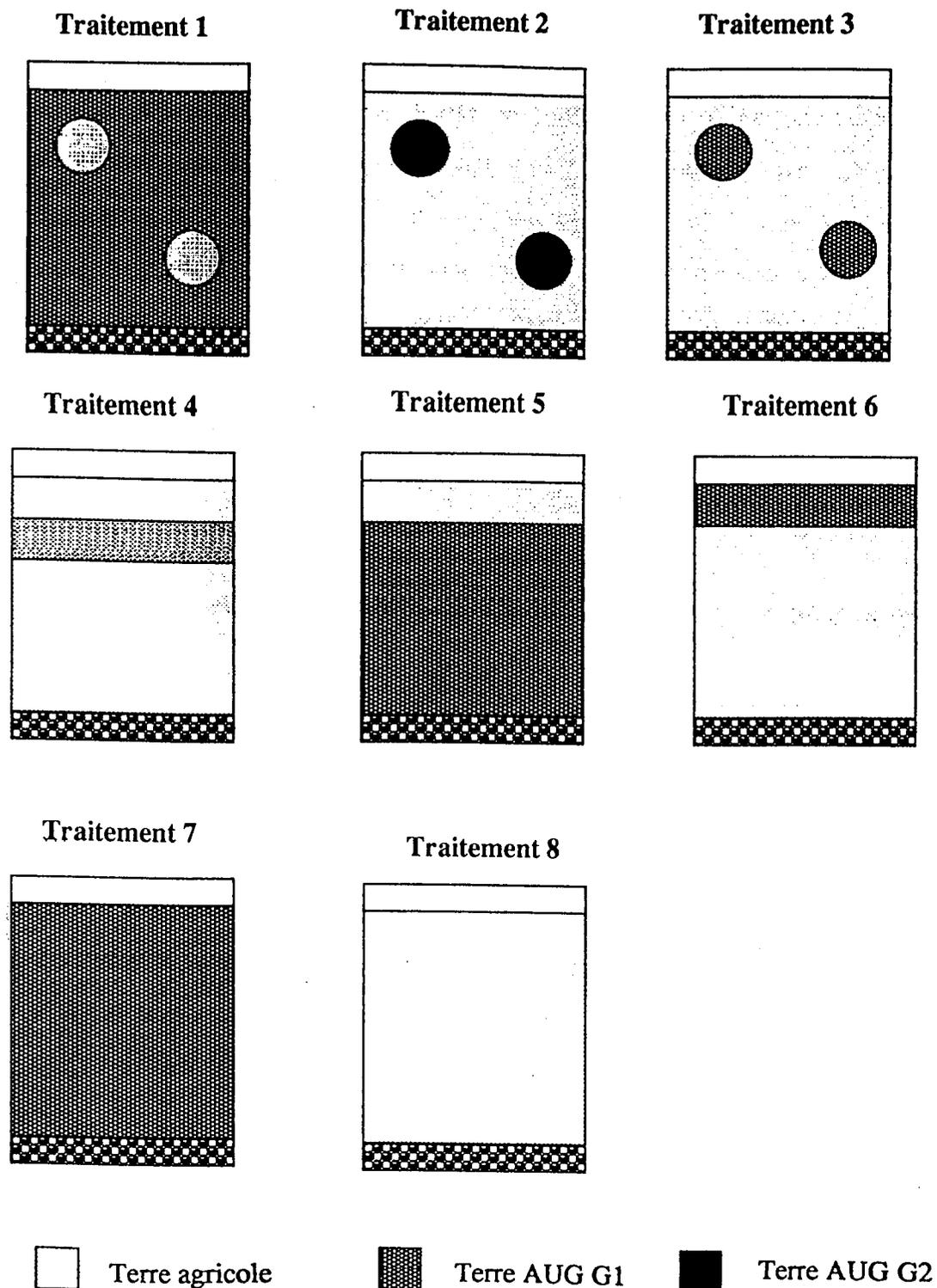
Figure 5 : Différentes modalités de remplissage des rhizotrons.
