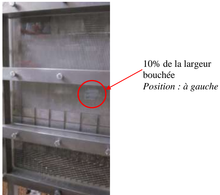
Figure 6- 6 : Position d'un défaut sur la maquette
