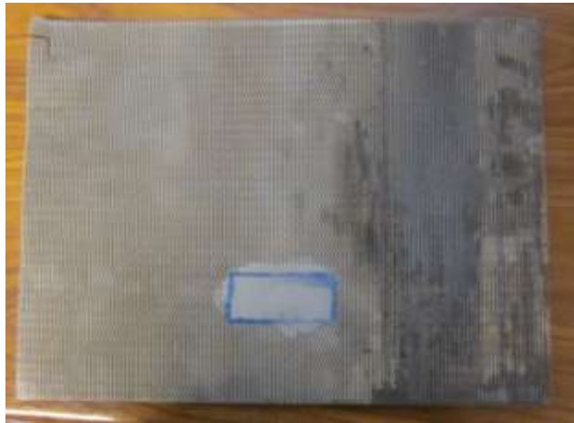
Figure 6- 9 : 20% de la largeur de la plaque d'ondes « serrated » bouchée au milieu de la plaque
