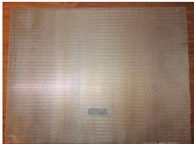
Figure 6- 8 : 10% la largeur de la plaque d'ondes « serrated » bouchée au milieu de la plaque
