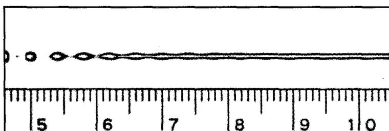
*Fig. 4 : Instabilité capillaire d'un jet circulaire
