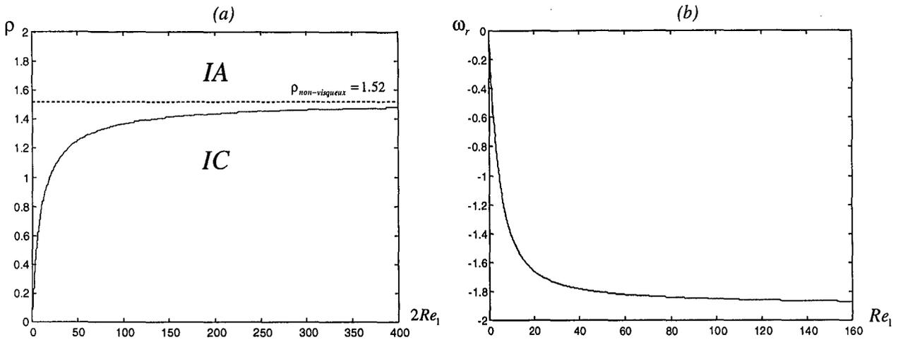
Fig. 58 : Influence de la viscosité sur la transition du jet chaud – Mode axisymétrique
