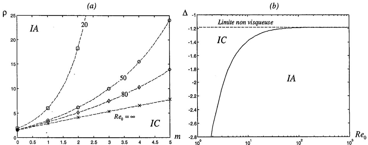
Fig. 46 : Influence de la viscosité sur les transitions du jet non tournant
