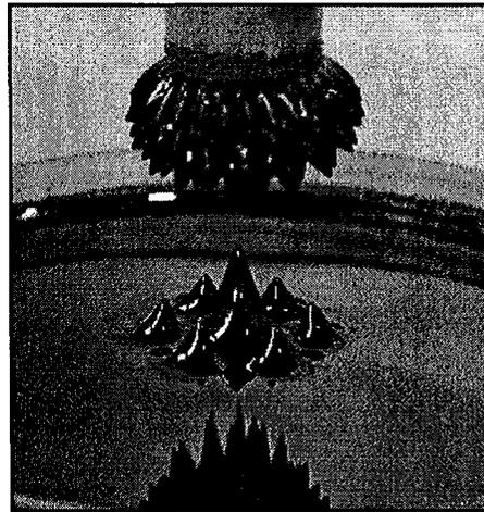
Cependant, si un champ magnétique est appliqué, les moments magnétiques des particules vont avoir tendance à s'aligner suivant la direction du champ. La polarisation macroscopique du fluide magnétique augmente avec la croissance du champ extérieur, jusqu'à ce que l'aimantation
