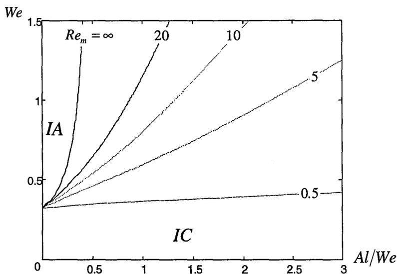
Fig. 34 : Influence du Reynolds magnétique sur la transition de tension de surface
