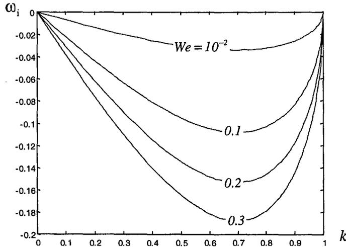
Fig. 6 : Influence déstabilisatrice de la tension de surface – Mode axisymétrique
