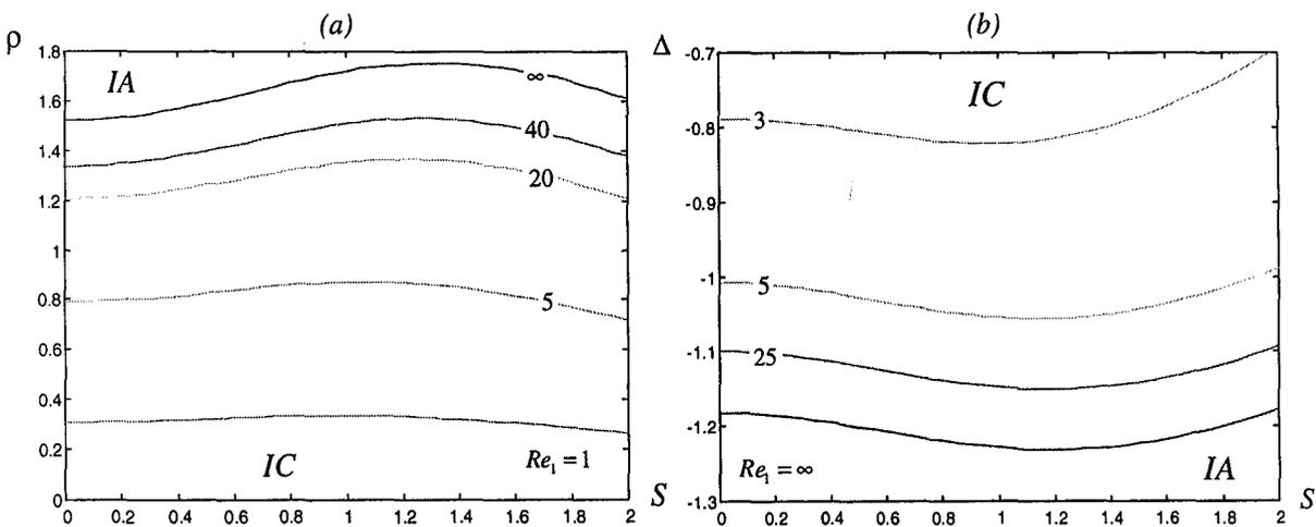
Fig. 59 : Influence de la viscosité sur la transition du jet tournant – Mode axisymétrique
