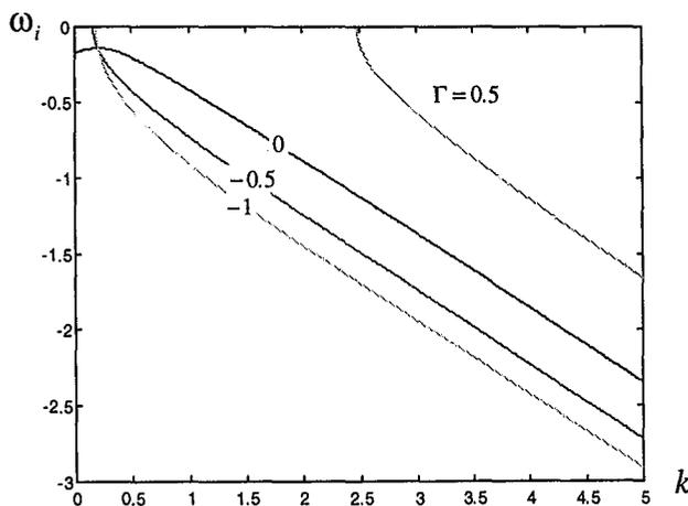
Fig. 18 : Influence de la circulation sur le jet submergé tournant – Mode asymétrique  $m = 2$
