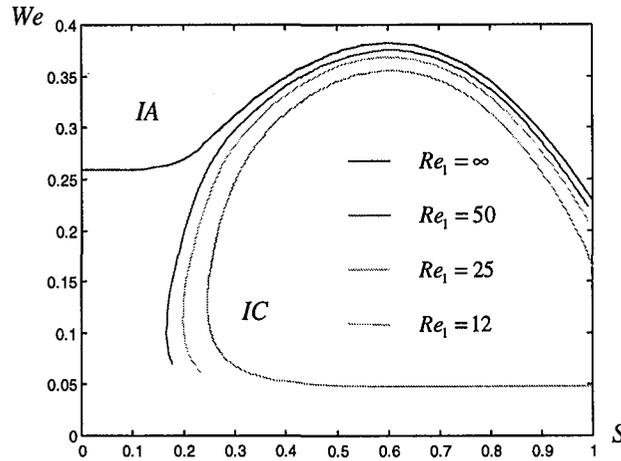
Fig. 56 : Influence de la viscosité sur la transition du jet capillaire tournant – Mode axisymétrique
