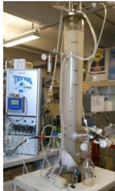
Figure II-4. Coupe longitudinale et photographie du réacteur de type airlift utilisé au cours de ce travail.
