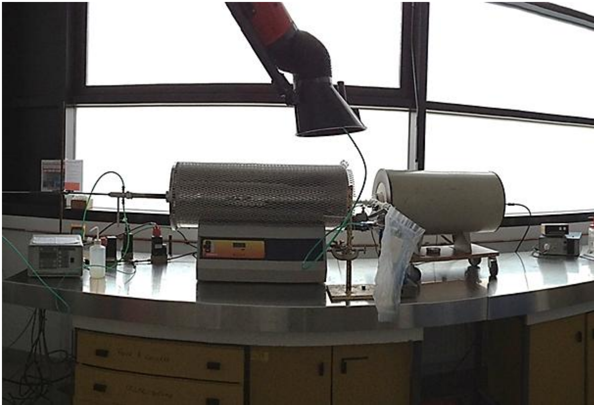
Figure II-28. Photo du montage expérimental couplant le réacteur tubulaire de pyrolyse (réacteur situé à gauche) et réacteur parfaitement auto-agité par jets gazeux (réacteur situé à droite).
