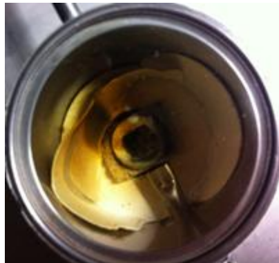
Figure II-11. Photo du réacteur vue de dessus après une expérience de pyrolyse sans la pièce anti-aérosols.
