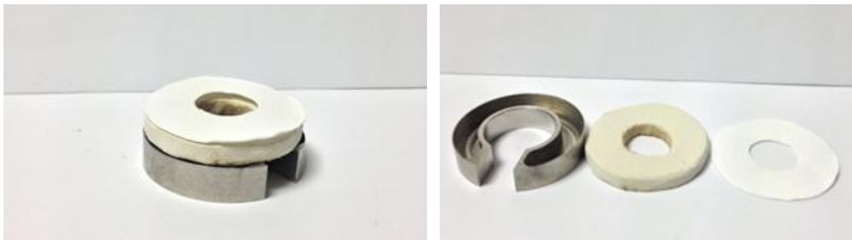
Figure II-10. Photos de la pièce anti-aérosols.
