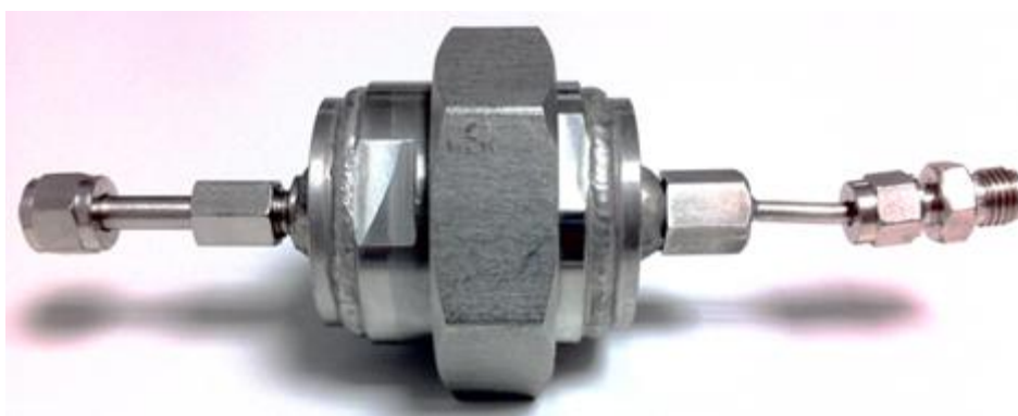
Figure II-15. Photo du piège à aérosols. En haut l'ensemble démonté avec un filtre. En dessous le piège monté, sens du gaz de la droite vers la gauche.
