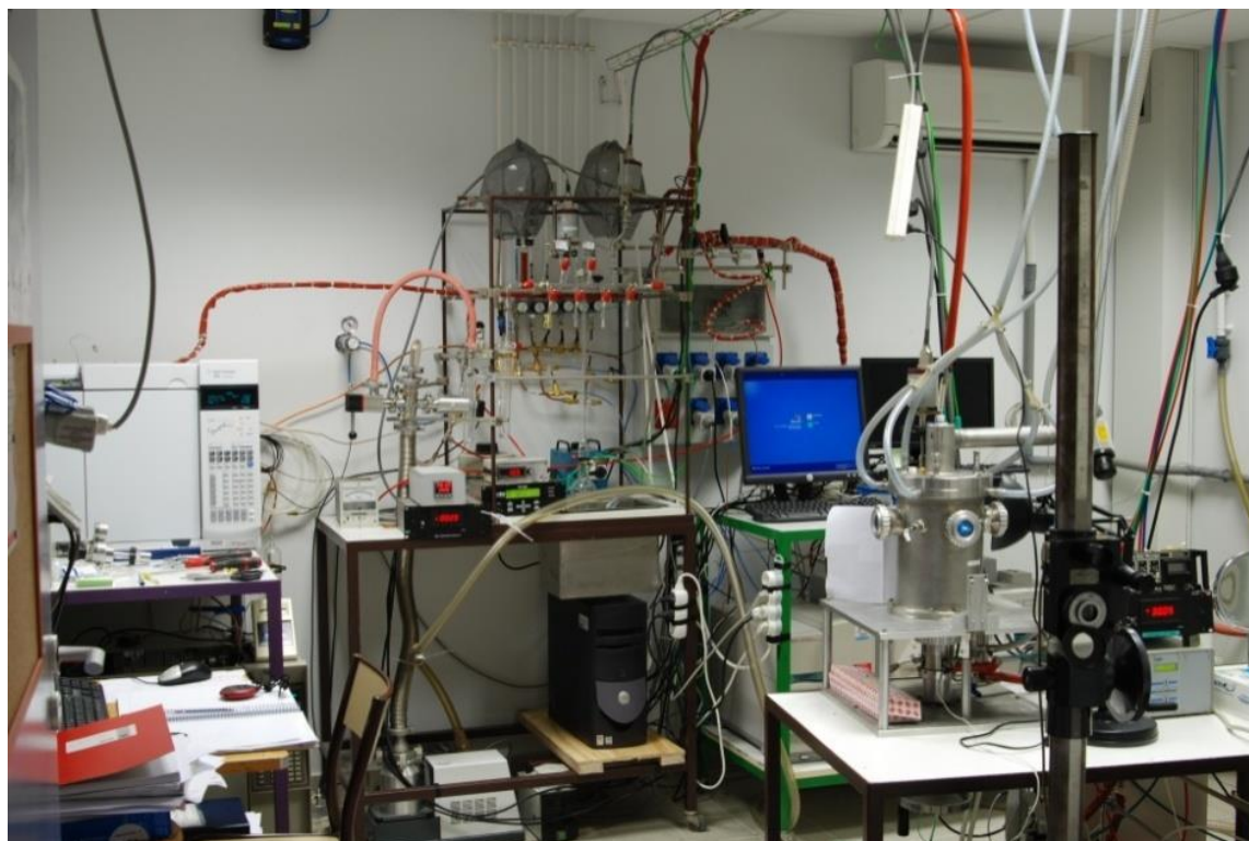
Figure 2.2. Vue réelle du dispositif de la flamme plate laminaire au LRGP.
