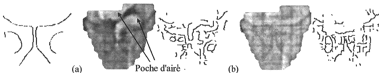
Figure V 52 : Causes de la dégradation des images du Portal Vision (a) Poche d'air. (b) Raquette.
