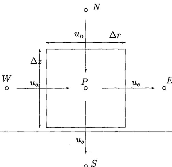
FIG. 2.14 – Représentation d'un volume de contrôle
