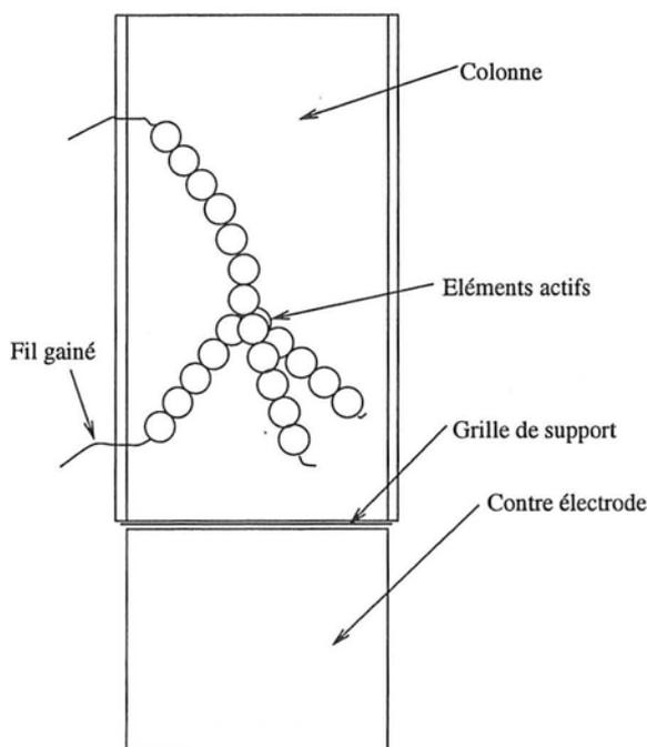
FIG. 1.11 – Positionnement des sondes dans la colonne
