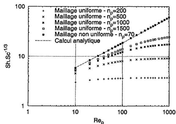
FIG. 2.20 – Comparaison des calculs effectués avec différents maillages
