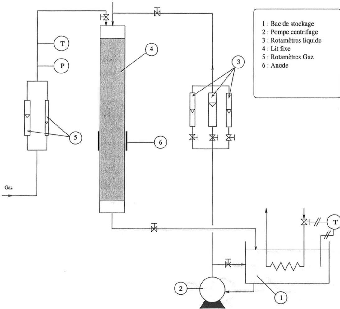
FIG. 1.1 – Dispositif expérimental
