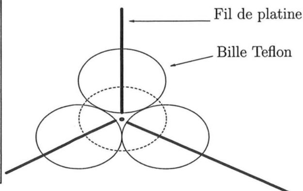
FIG. 1.9 – Assemblage des sondes
