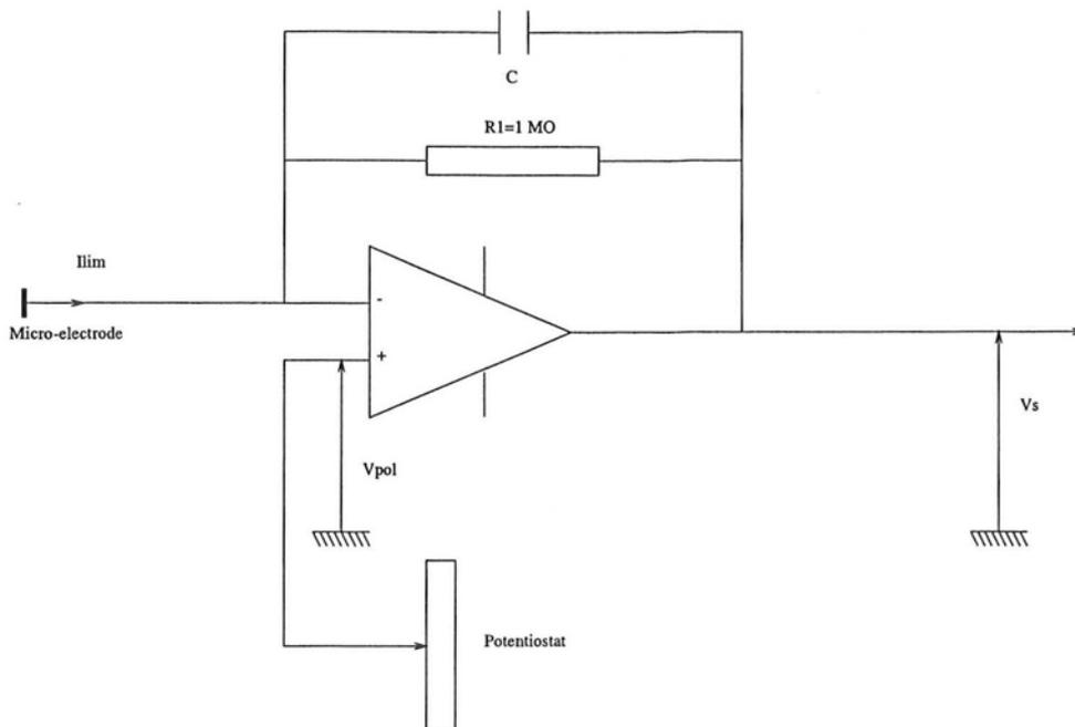
FIG. 1.12 – Schéma de principe du convertisseur courant/tension
