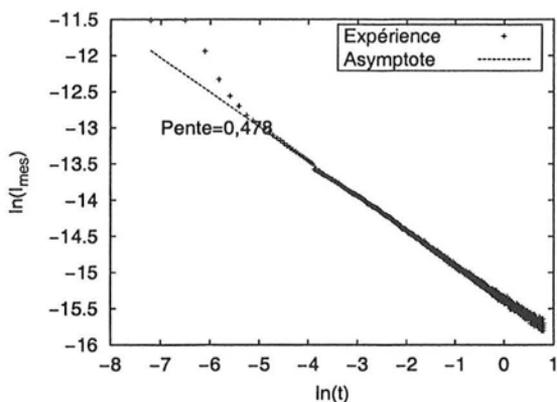
FIG. 1.13 – Réponse à un échelon de polarisation
