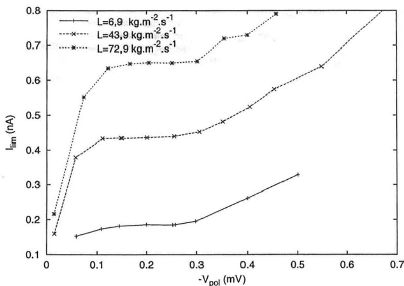
FIG. 1.15 – Courbes intensité-potentiel pour différents débits de liquide
