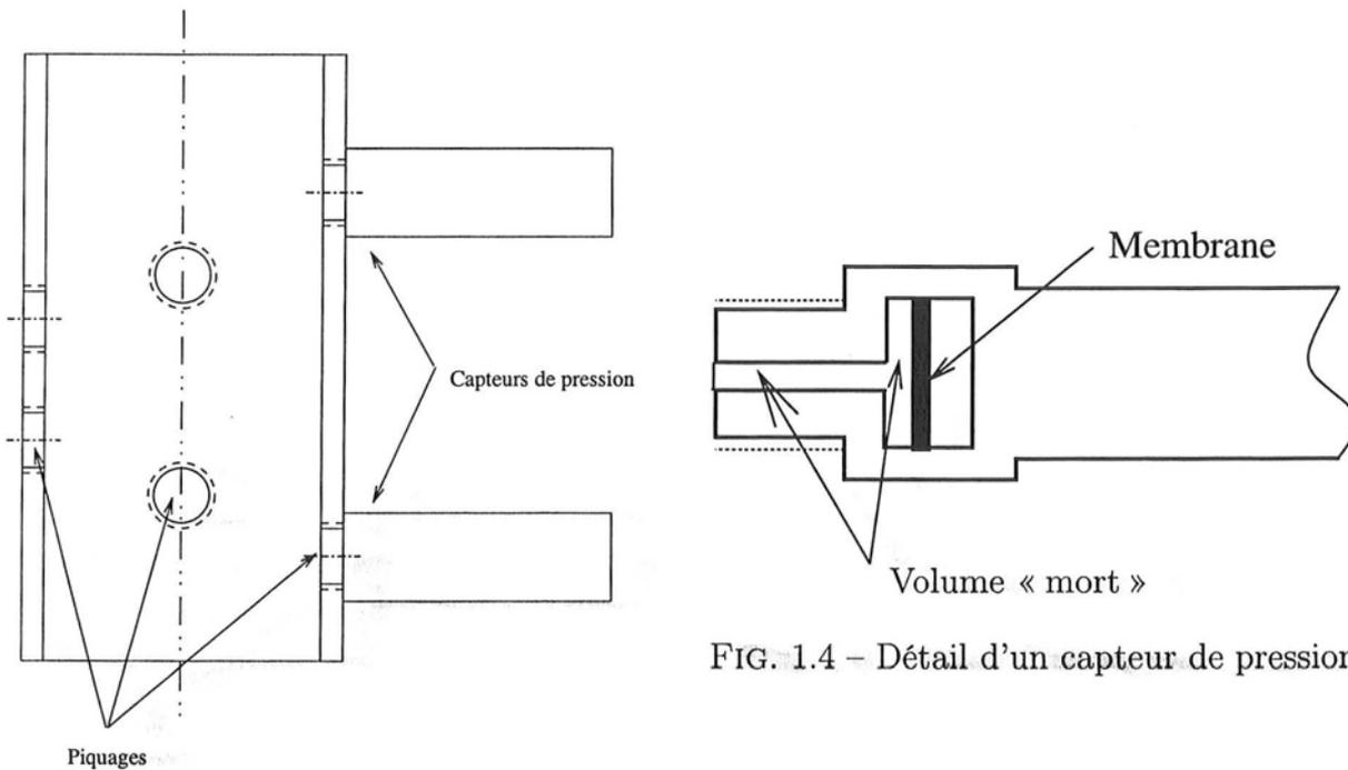
FIG. 1.3 – Positionnement des capteurs de pression
