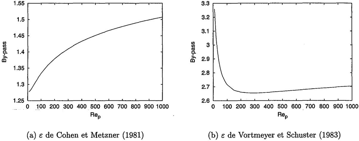
FIG. 2.8 – Quantification de l'effet de paroi
