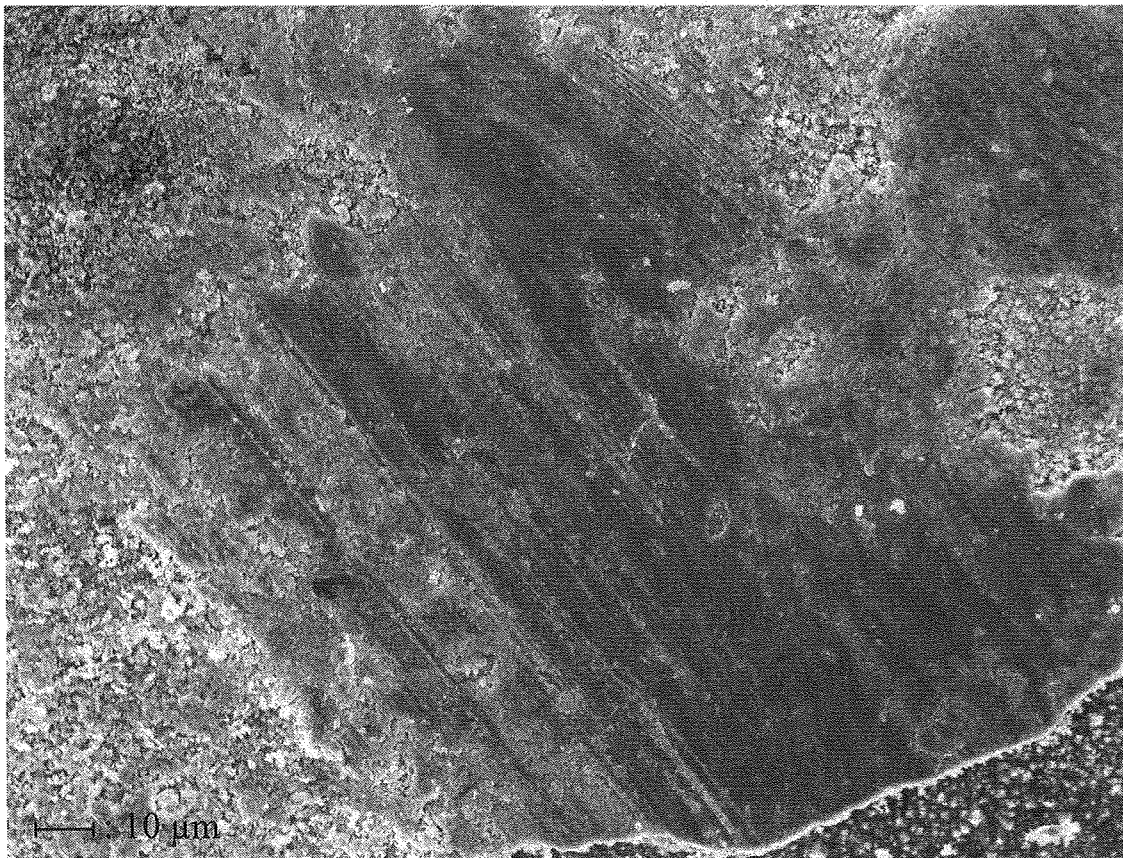
Figure 37 : Image MEB du revêtement \{111\} après frottement contre le disque HSS, sous vapeur d'eau à faible charge (0.2 N)
