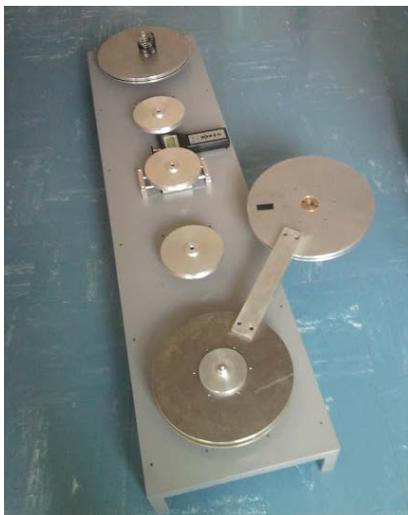
**Figure A-2 :** Photographie du dispositif permettant de réaliser des bobinages en double galettes.
