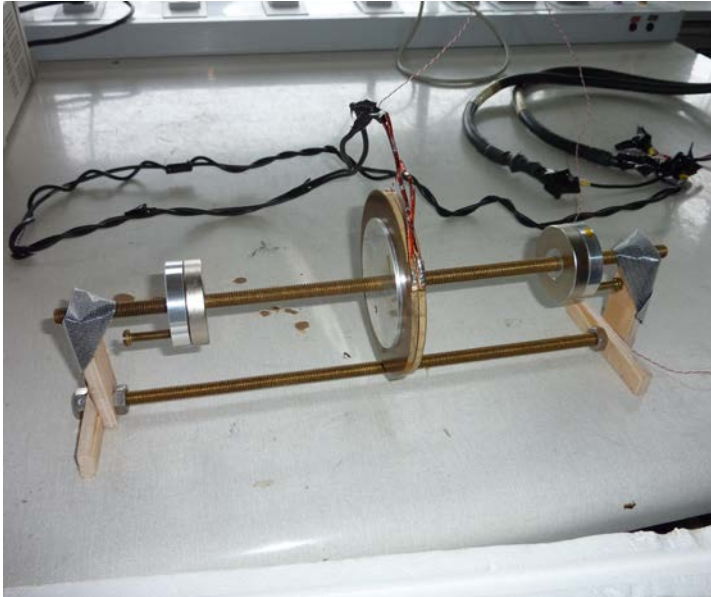
Figure 4-5 : Photographie du dispositif expérimental utilisé pour caractériser le ruban BiSCCO .
