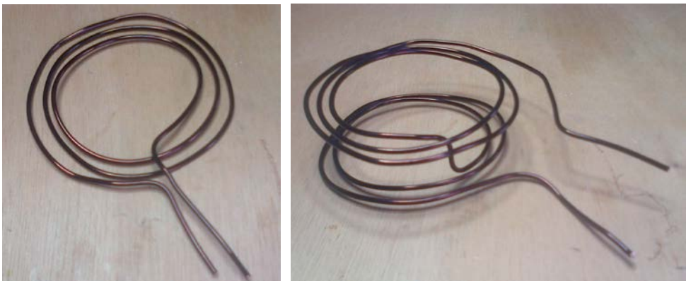
Figure A-1 : Photographies illustrant le principe des bobinages simple galette (gauche) et double galettes (droite).
