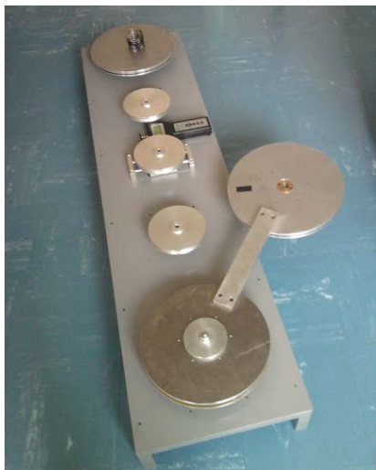
Figure A-2 : Photographie du dispositif permettant de réaliser des bobinages en double galettes.
