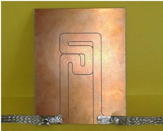
Figure 5-15 : Circuit électrique gravé dans une plaque d'époxy cuivrée.
