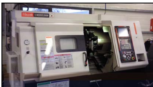
Figure III. 18. Tour horizontal à commande numérique MAZAK 200M
