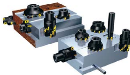
Figure I. 1. Représentation de différentes opérations et outils de fraisage, d'après Sandvik [1]
