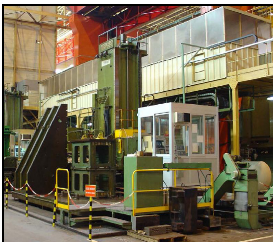
Figure III. 4. Centre d'usinage horizontal SASS MORANDO utilisé pour le forage avec technologie BTA-STTS
