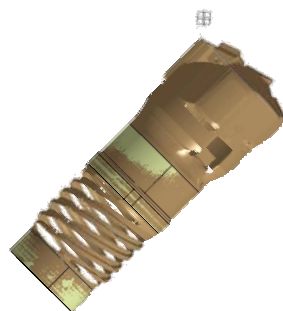
Figure II. 24. Nuage de points issu de la numérisation de l'outil BTA Ø19,28mm (ref. BTU-002FBA19,28 UX-2D TAA)
