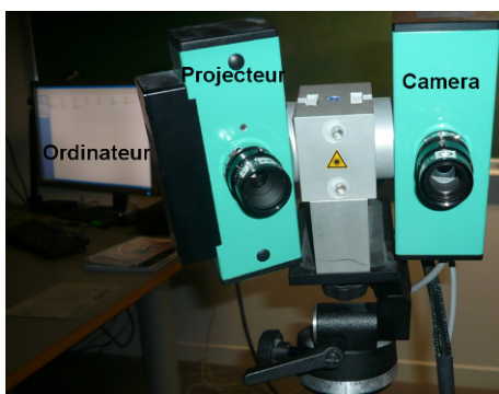
Figure II. 23. Dispositif de numérisation
