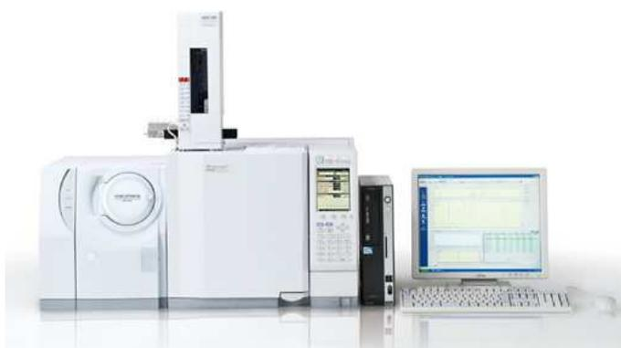
**Figure II-12 - Photographie de l'appareil GC-MS Shimadzu QP2010 SE**
