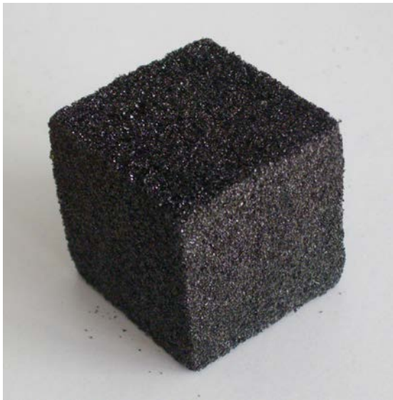
Figure 28 : Mousse rigide à base de tanin et image complémentaire agrandie
