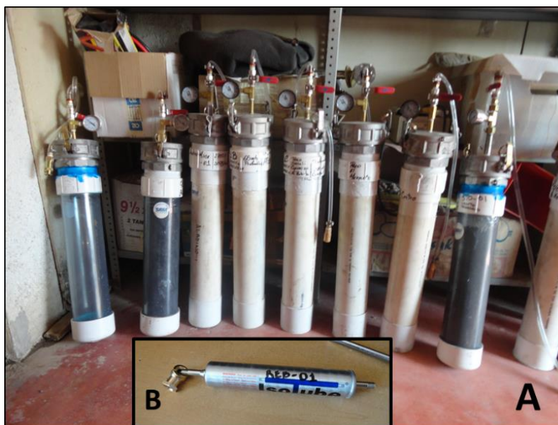
Figura 59. A y B: Fotografía A, Canisters de PVC, contruidos para muestrear gas de carbón. Fotografía B, Isotubo para desorber el gas de los Canister, y enviarlos al laboratorio de análisis isotópico.
