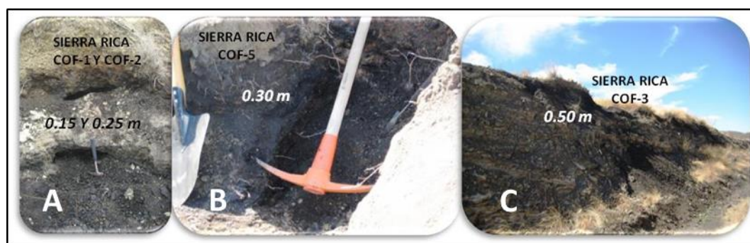
Figura 62. A, B y C algunos de los principales afloramientos de carbón del área de Sierra Rica, la mayoría de los afloramientos de carbón en esta zona son de bajo espesor.
