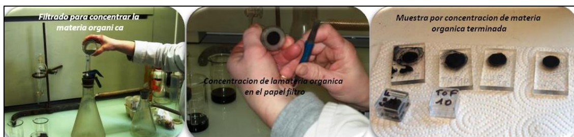
Figura 9. Filtrado y concentración de la materia orgánica, (MO), después del centrifugado, y lámina terminada por concentración de MO.
