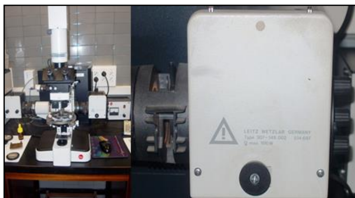
Figura 15. Microscopio Leitz® Wetzlar tipo 307, con un objetivo de 50x a inmersión de aceite (n= 1.515). Medida en luz reflejada de longitud de onda 546 µm.
