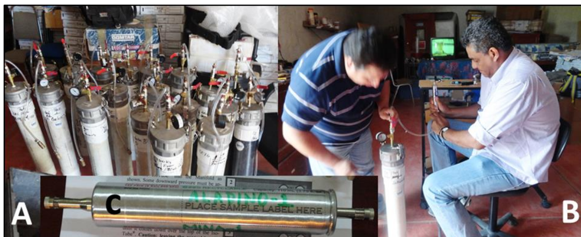
Figura 60. A, B y C. Proceso de desorción y llenado de isotubos con gas de carbón.
