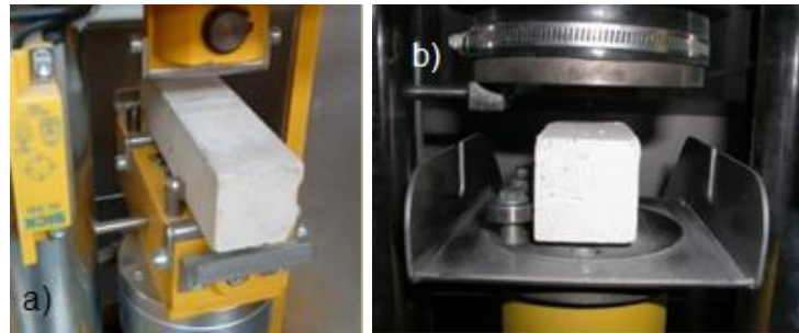
Figures 25. Presse pour mesurer la résistance en flexion (a) et en compression (b)
