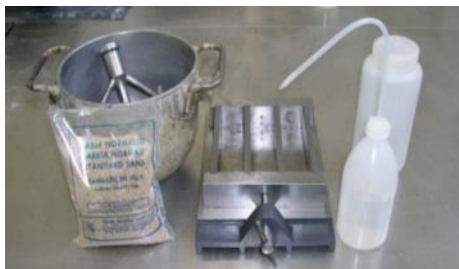
Figure 22. Bol, sable normalisé, moule de 4 \times 4 \times 16 \text{ cm}^3 et eau distillée utilisés pour la fabrication des mortiers normalisés
