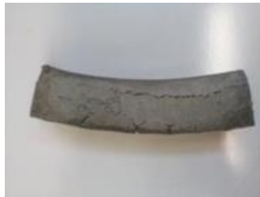
Figure 138. Photographie d'une éprouvette contenant 27 % d'anhydrite
