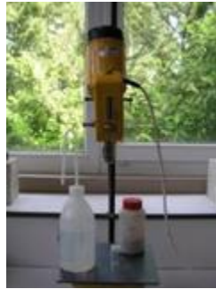
Figure 29. Eau distillée, ciment et rotor utilisés pour la fabrication des pâtes de ciment
