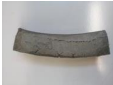
Figure 138. Photographie d'une éprouvette contenant 27 % d'anhydrite
