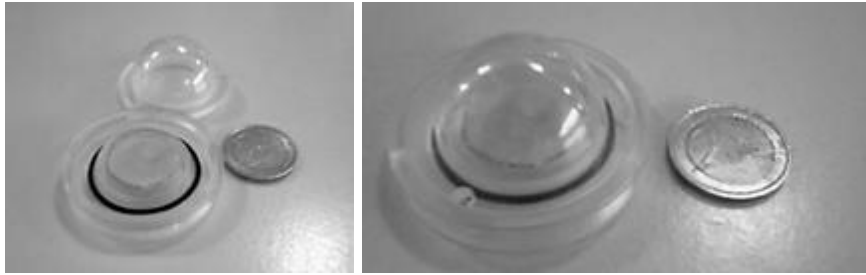
Figures 31. Dispositif expérimental pour la DRX in situ
