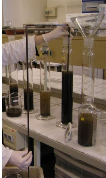
*Figure 13 : Siphonage des limons fins*
