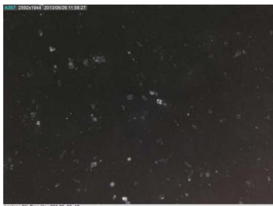
**Figure 14** Observations en microscopie numérique du sirop de lactose à une concentration massique de 5%, après agitation de la solution pendant 24h. Agrandissement : 250x.
