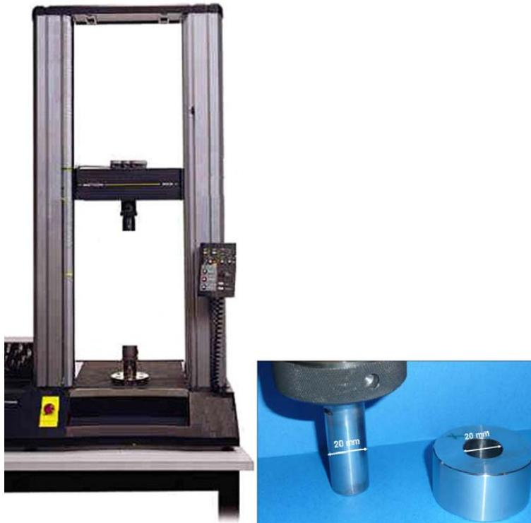
***Figure 17 Photographies d'une presse uniaxiale Instron 5569® (à gauche), ainsi que du poinçon et de la matrice utilisés de diamètre 20 mm (à droite).***
