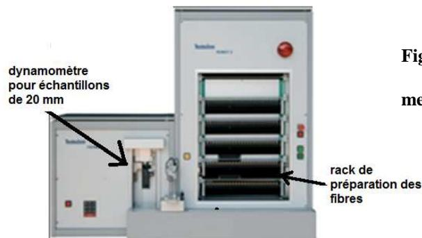
Figure 6 Appareil de mesure type Favimat
