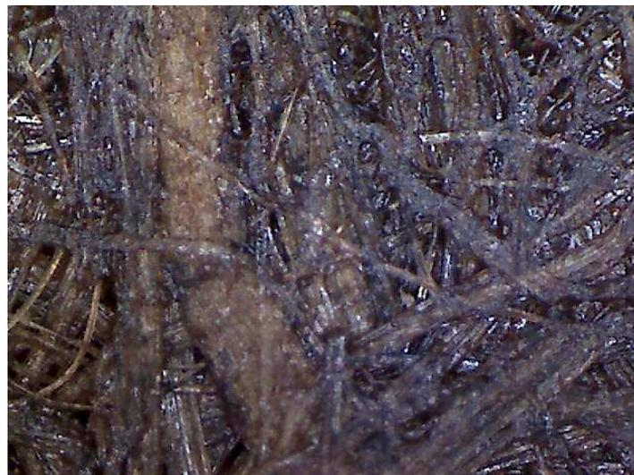
**Figure 20: Vue du biocomposite LIN AT (x200)**
