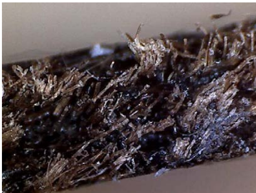
Figure 12 Lin bt vue en coupe grossissement 200 fois
