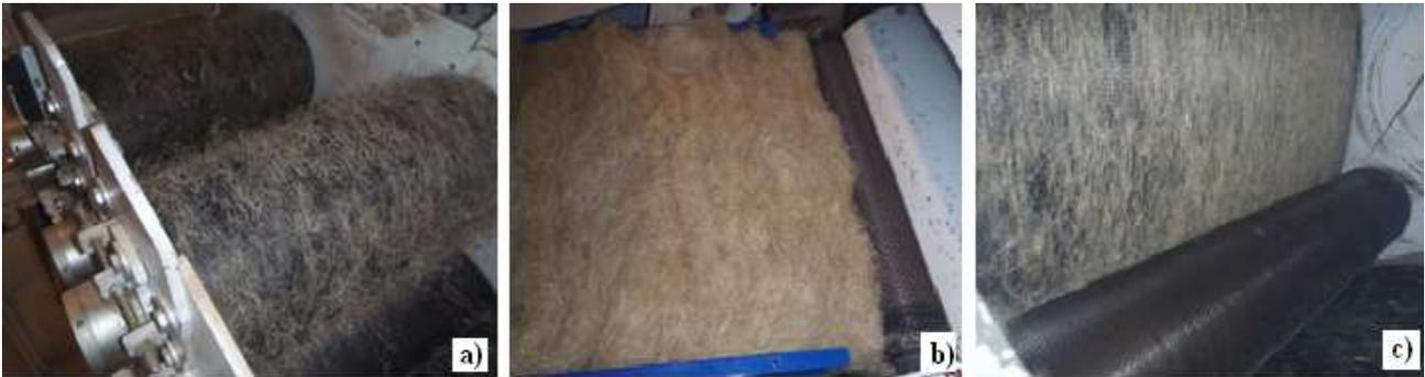
**Figure 2 pour le réglage 5 de la fibre CHAN1 : a) vue des travailleurs b) matelas d'entrée c) vue du tambour principal**
