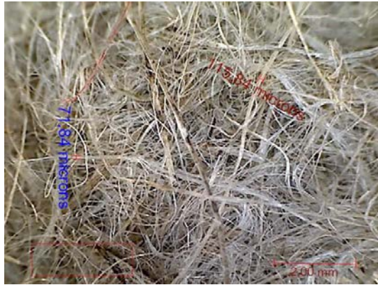
Figure 14 nontissé lin vue de dessous : pas de trous visibles
