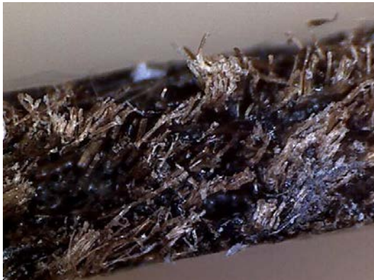
Figure 12 Lin bt vue en coupe grossissement 200 fois
