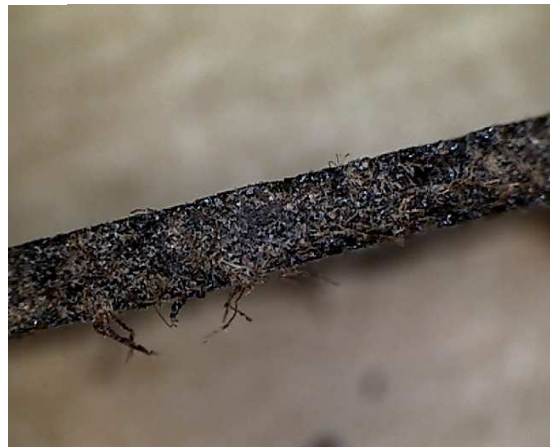
Figure 35 Composite P9ct en coupe (x30)
