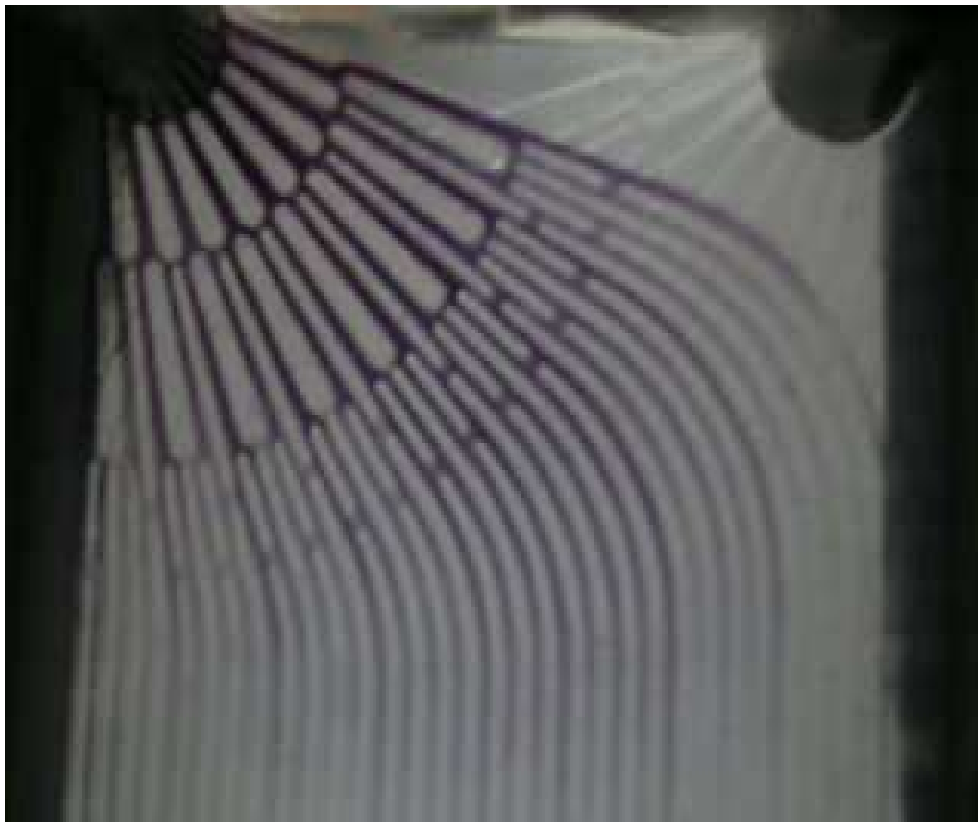
Figure 6.34 : Distribution expérimentale de la solution de nigrosine dans les canaux réactifs.
