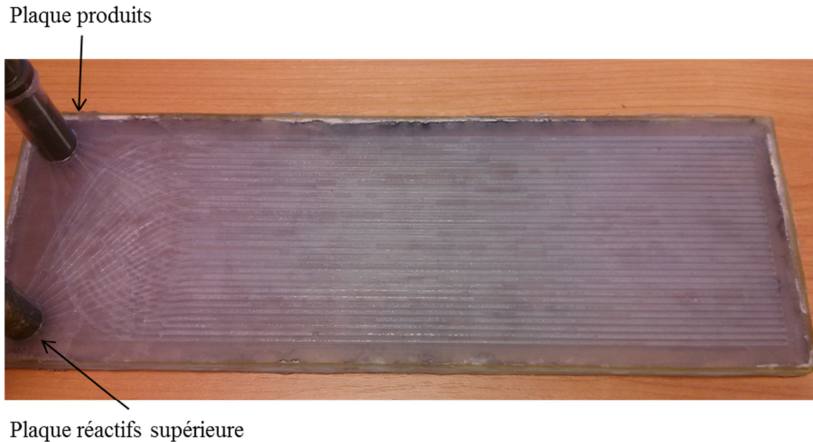
Figure 6.32 : Photographie de la maquette froide utilisée pour étudier expérimentalement la distribution dans l'ETR.
