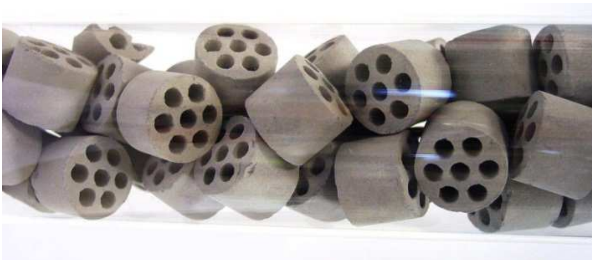
Figure 1.11 : Exemple de catalyseur de reformage (source Air Liquide).
