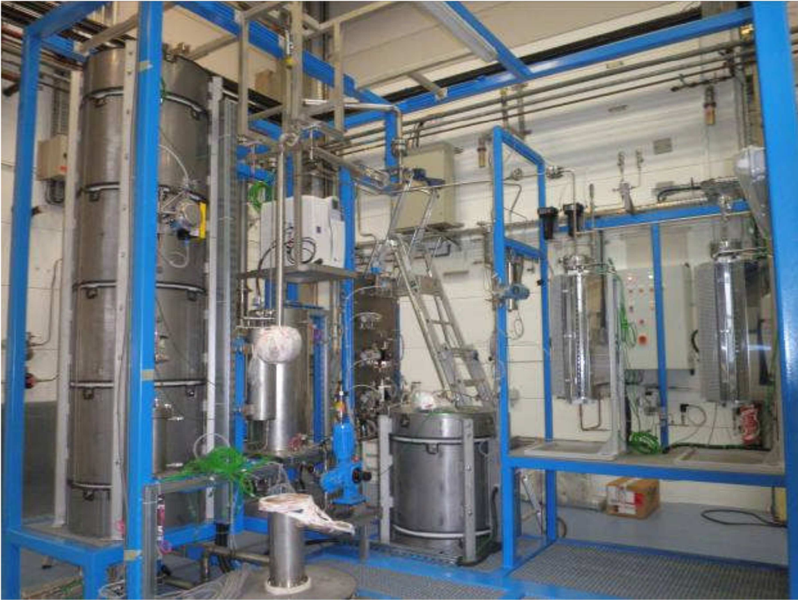
Figure 5.36 : Photographie du pilote de démonstration pour évaluer les performances des échangeurs-réacteurs conçus.
